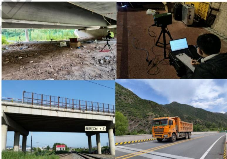
基于移动车辆的桥梁快速评估与诊断工程应用现场
