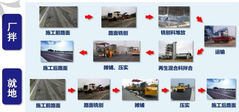
沥青路面再生施工流程
