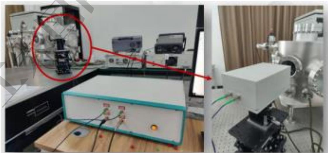
激光测振传感器控制箱与测头
