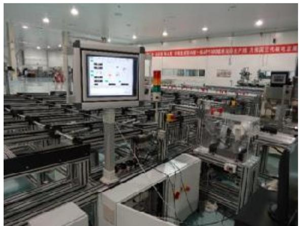
燃料棒装配、焊接，传输、检测生产线
