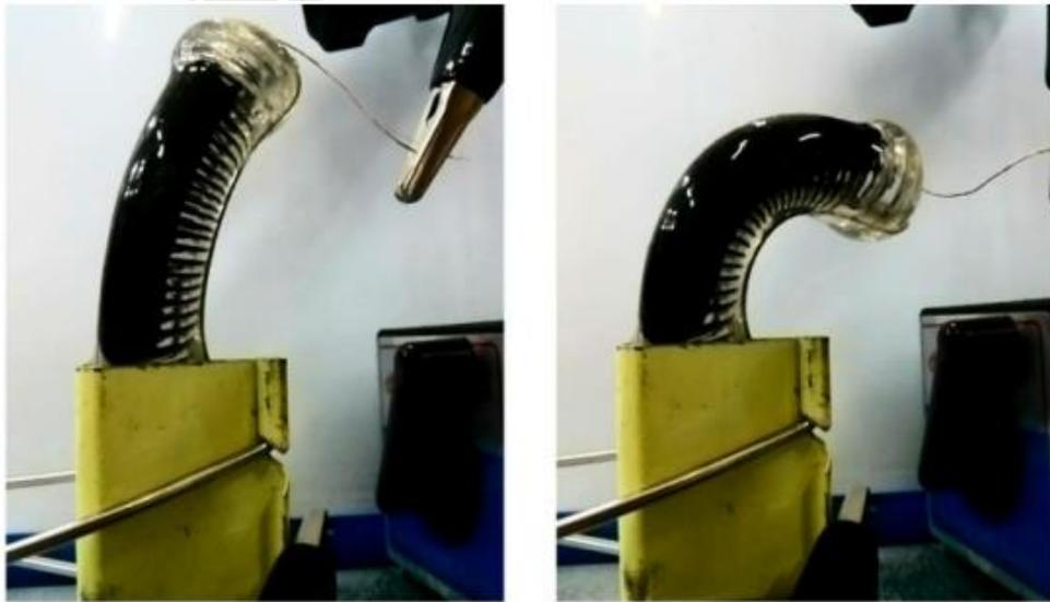
介电弹性体驱动器产生弯曲大变形
