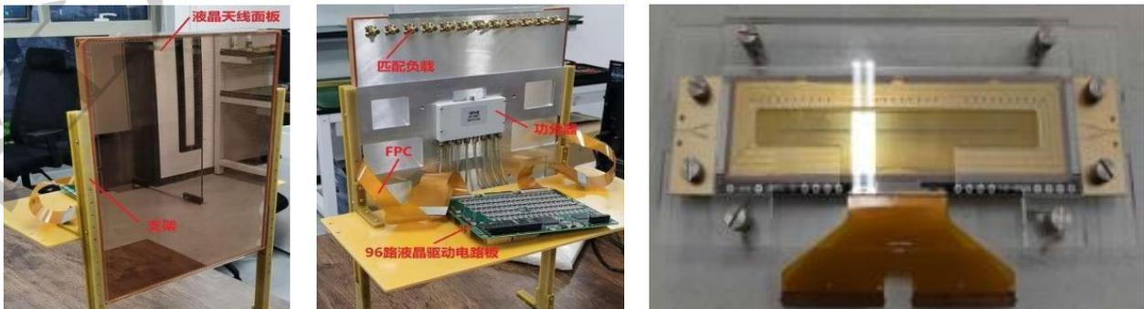
本课题组研发的液晶相控阵原理样机
