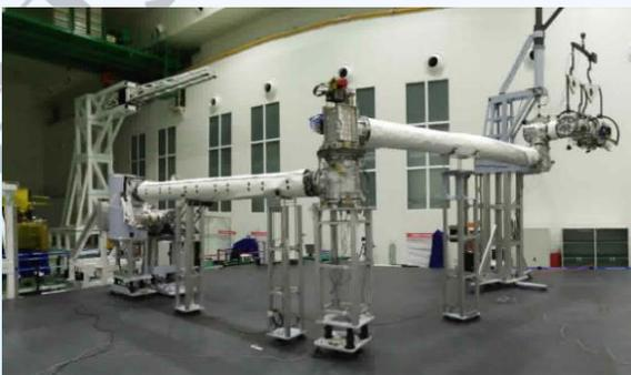
空间机械臂初样零重力装配试验系统
