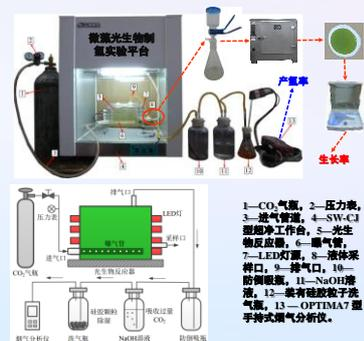
平板气升式光生物反应器实验平台及其原理图
