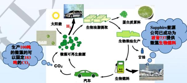
微藻可再生能源的零污染循环利用过程
